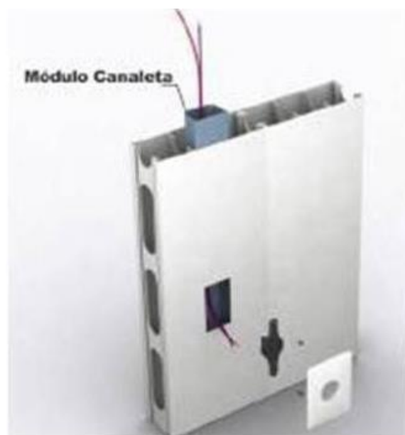
Figura 6 – Perfil canaleta dentro do módulo básico e vista de abertura para a fixação de caixinha elétrica
