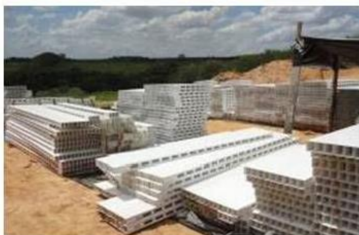
Figura 12 – Painéis de PVC pré-moldados na fábrica
