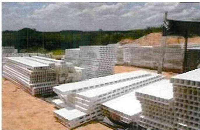
Figura 12 – Painéis de PVC pré-moldados na fábrica
