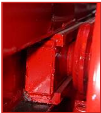
Sapatas em polímero / Patines en polímetro Slide shoe in polymer
